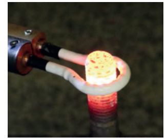
› Erwärmen eines Gewindebolzens mit der wassergekühlten Spule
