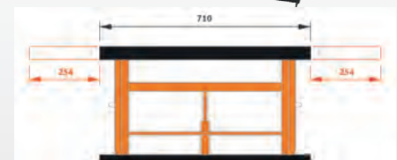
MHB 680 mit seitlicher Erweiterung
