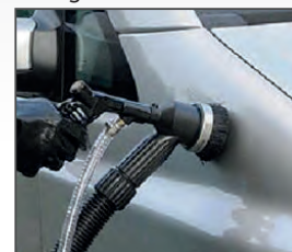
▶ Sandstrahlmittel wird nach dem Auftreffen auf die Oberfläche sofort wieder abgesaugt und zurückgeführt
