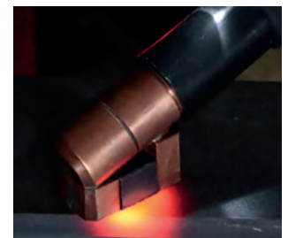
› Erwärmen eines Bauteils mit der Fokusspule seitlich
