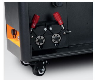
Drahtvorschubeinheit mit vier Förderrollen
